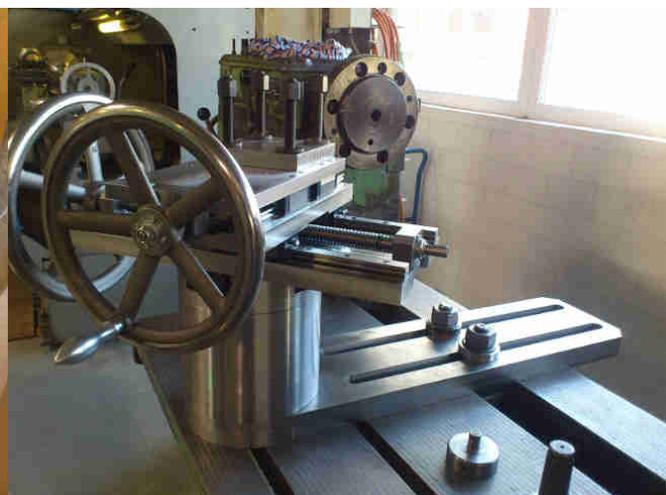
**Kreuzschlitten zu Druckbank Höhe 300mm
