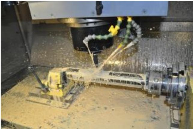
Wir verfügen über CNC Fräsmaschinen welche uns erlauben Teile klein bis zu X=3000mm Y=800mm Z=800mm mit höchster Präzision zu bearbeiten.
